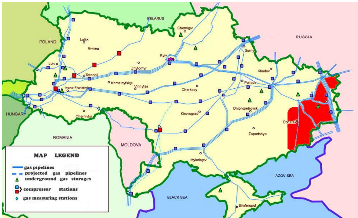
Рисунок 2. Украинская ГТС с малой детализацией сети газопроводов (См. легенду карты для расшифровки условных обозначений)
